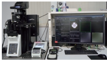
共焦点レーザー顕微鏡 confocal laser microscope FV3000
